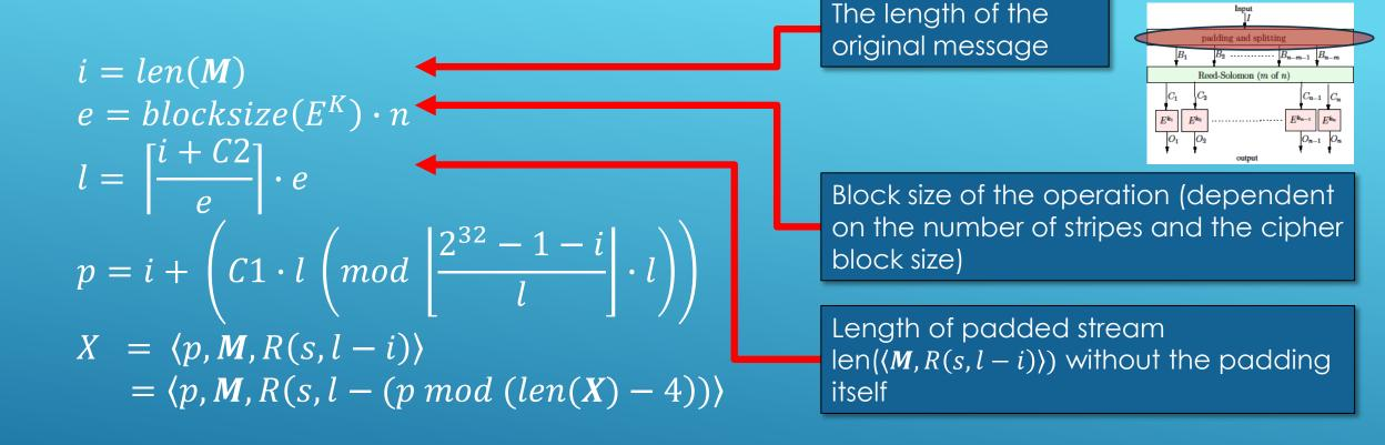
THE addRedundancy OPERATION (3)
