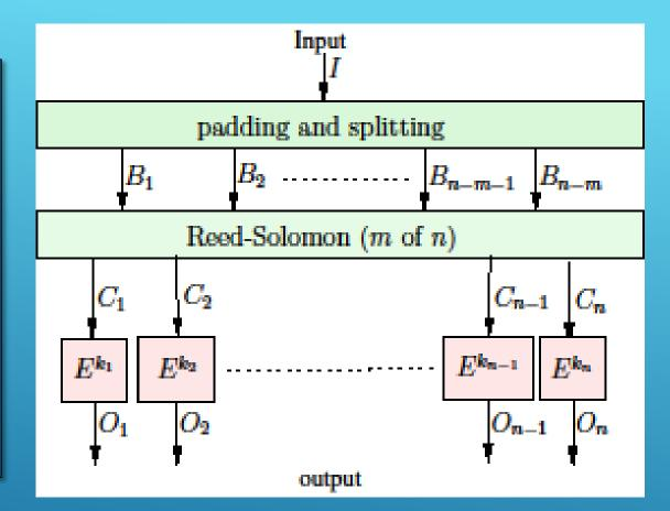
THE addRedundancy OPERATION (1)
